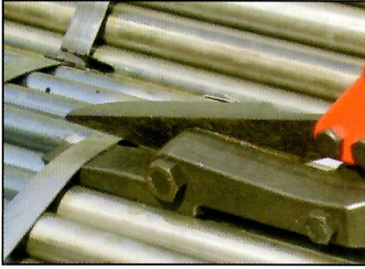
④ 帯鉄が可動刃の内側に入るまで打撃を加える
