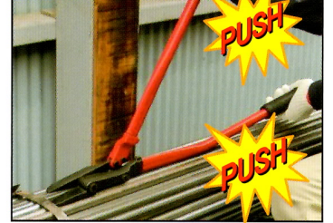
③ ストライカーを前後に操作し数回打撃する
